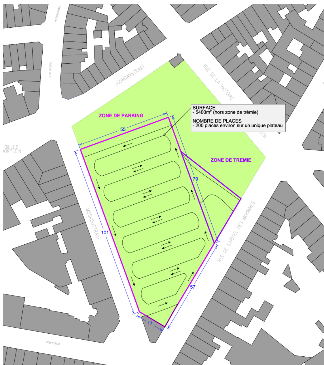
Principe d'implantation de la variante 1
